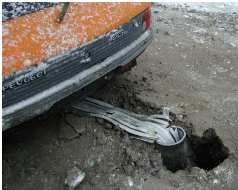
energie absorberende constructie na een aanrijding
