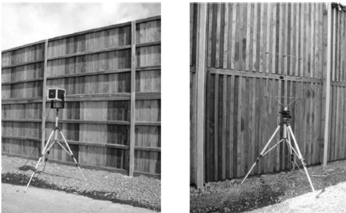
Figuur 2 - testopstelling met geluidsbron en microfoon
